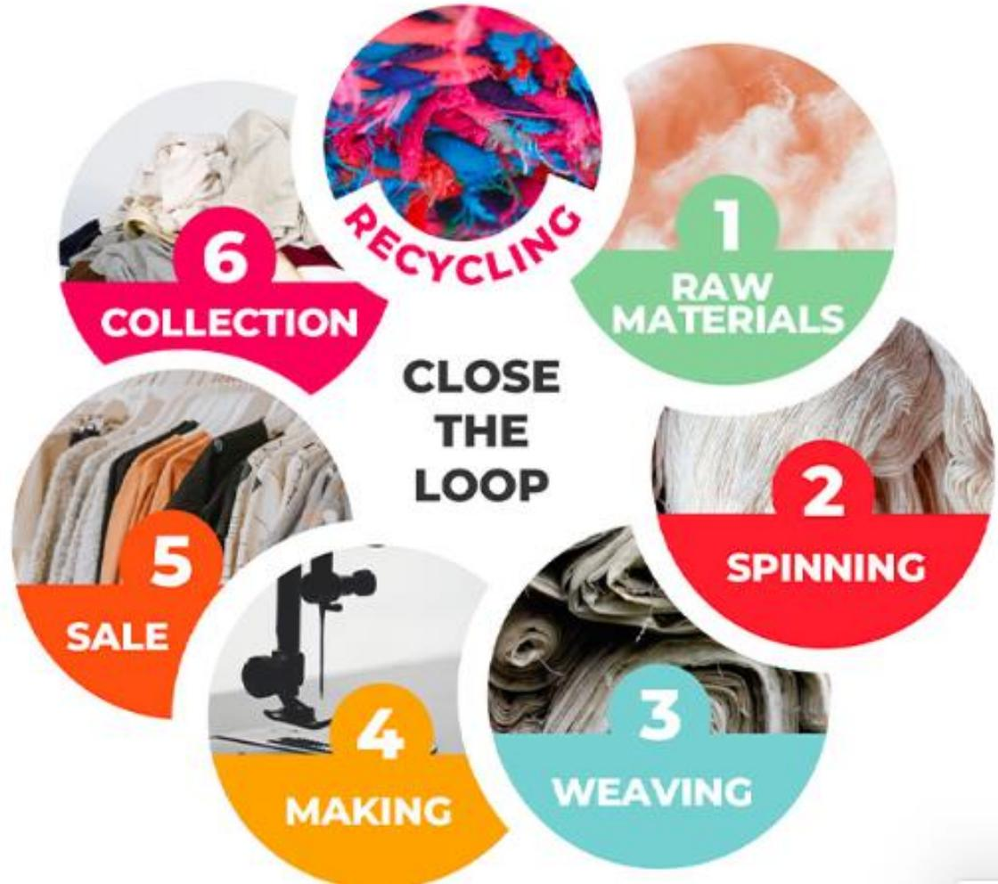
**MATERIAS PRIMAS:** Dos orígenes: por una parte aprovechamos los cortes de tela y los re-convertimos en fibra, clasificando según colores y composición (PRE CONSUMER) y por otra, utilizamos prendas usadas clasificándolas también según color y composición, de las que se extraen los componentes no reciclables (botones, cremalleras, etc) y la parte reciclable se reconvierte en fibra (POST CONSUMER).
